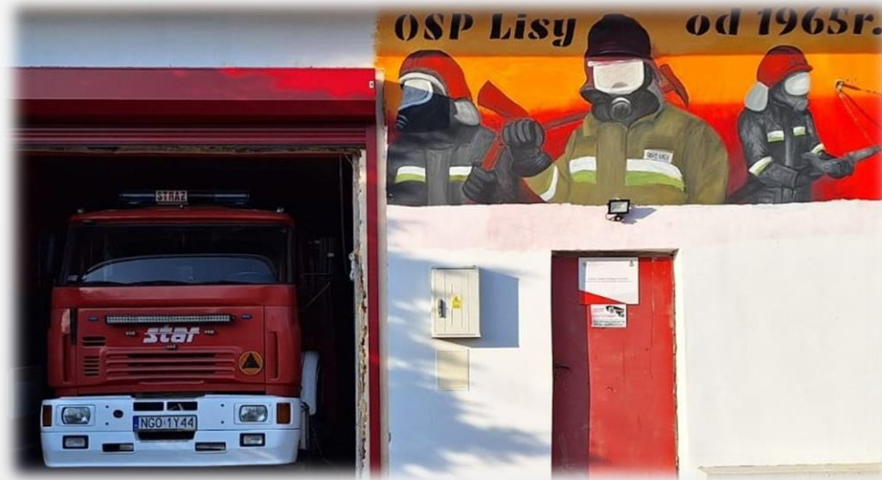
Średni samochód ratowniczo-gaśniczy GBARt 2,5/20 Jelcz, na podwoziu Star 1142 OSP Lisy, gm. Banie Mazurskie
